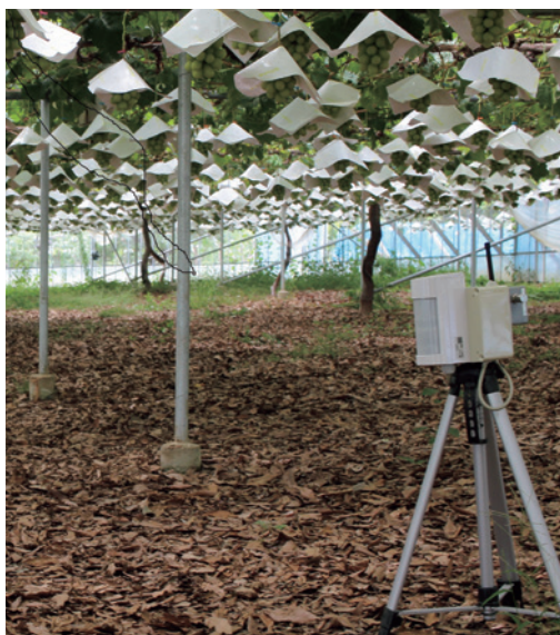
畑に設置した果樹盗難対策用の人感センサー
