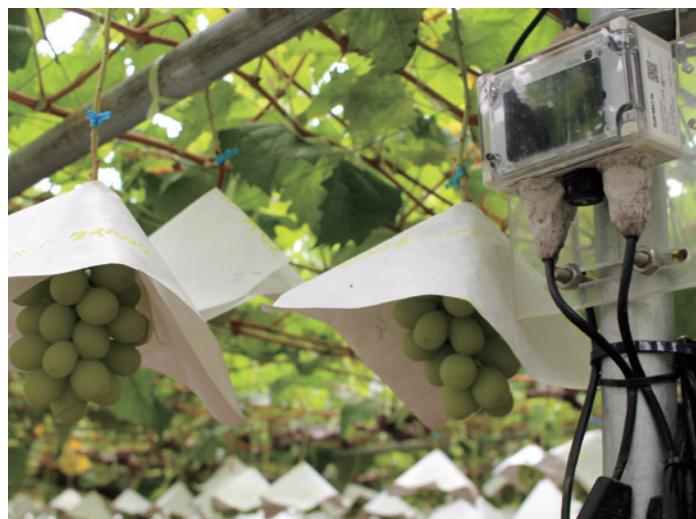
畑に設置した環境センサー 太陽光により稼働し、温度湿度等をセンシングする
